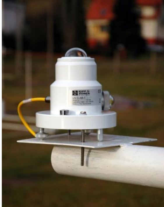
UV-S-AB-T firmy KIPP&ZONEN w Borucinie
