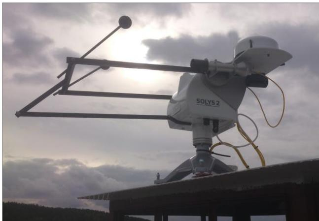
Począwszy od listopada 2014 r. w Borucinie rozpoczęto pomiary ciągłe promieniowania bezpośredniego pyrheliometrem SHP-1 i rozproszonego pyranometrem SMP-11 firmy KIPP&ZONEN, umieszczonych na platformie Sun Tracker SOLYS 2 (fot. po lewej).
