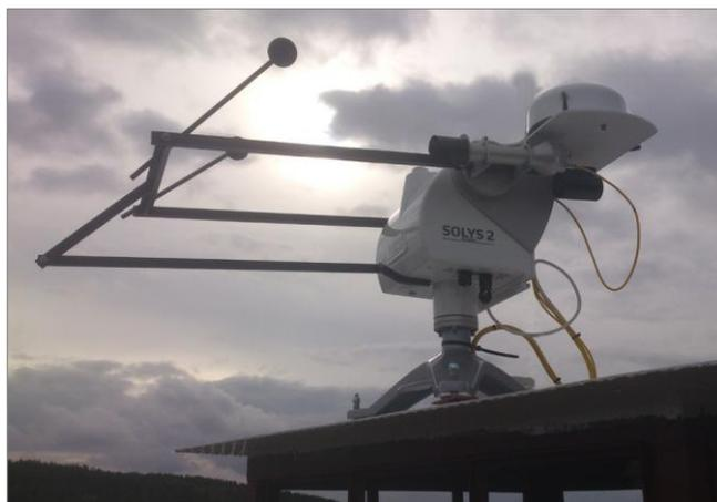
Począwszy od listopada 2014 r. w Borucinie rozpoczęto pomiary ciągłe promieniowania bezpośredniego pyrhelemetrem SHP-1 i rozproszonego pyranometrem SMP-11 firmy KIPP&ZONEN, umieszczonych na platformie Sun Tracker SOLYS 2 (fot. po lewej).
